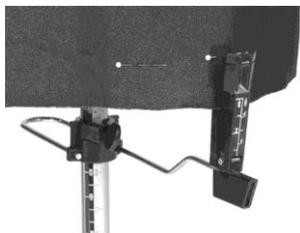
Разместите ограничитель подола на нужную высоту. Поместите ткань в пластиковый зажим, закройте зажим и вставьте булавку в отверстие сверху зажима. Откройте зажим, двигайте ограничитель по кругу.
