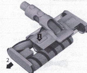
2. Очистите роликовую щетку и прозрачную крышку
